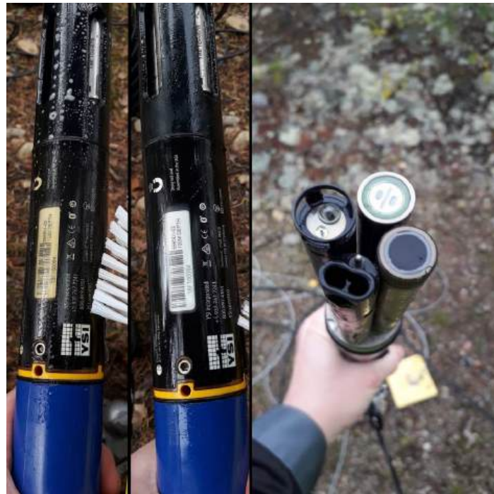
Sondin tummuminen (vasen) sekä anturipäiden puhtaus noin 6 kuukauden puhdistamatta olemisen jälkeen
