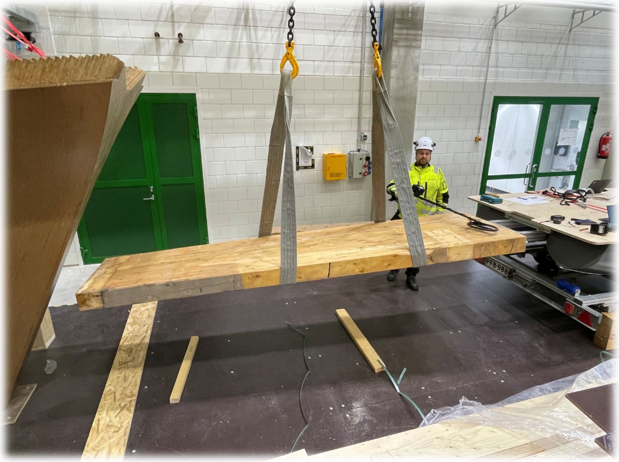
Kuva 4. Koeasetelma, liimapuupalkki nostettu tutkimuksen ajaksi siltanosturilla ilmaan.
