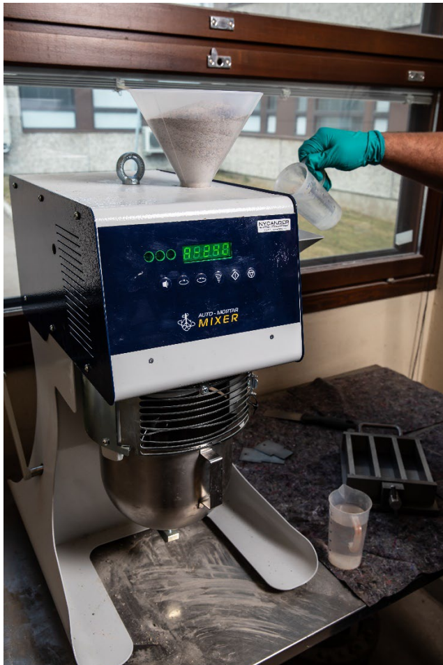
Kuva 5. Tutkimuksessa käytetty laastisekoitin (Eloaho 2023)
