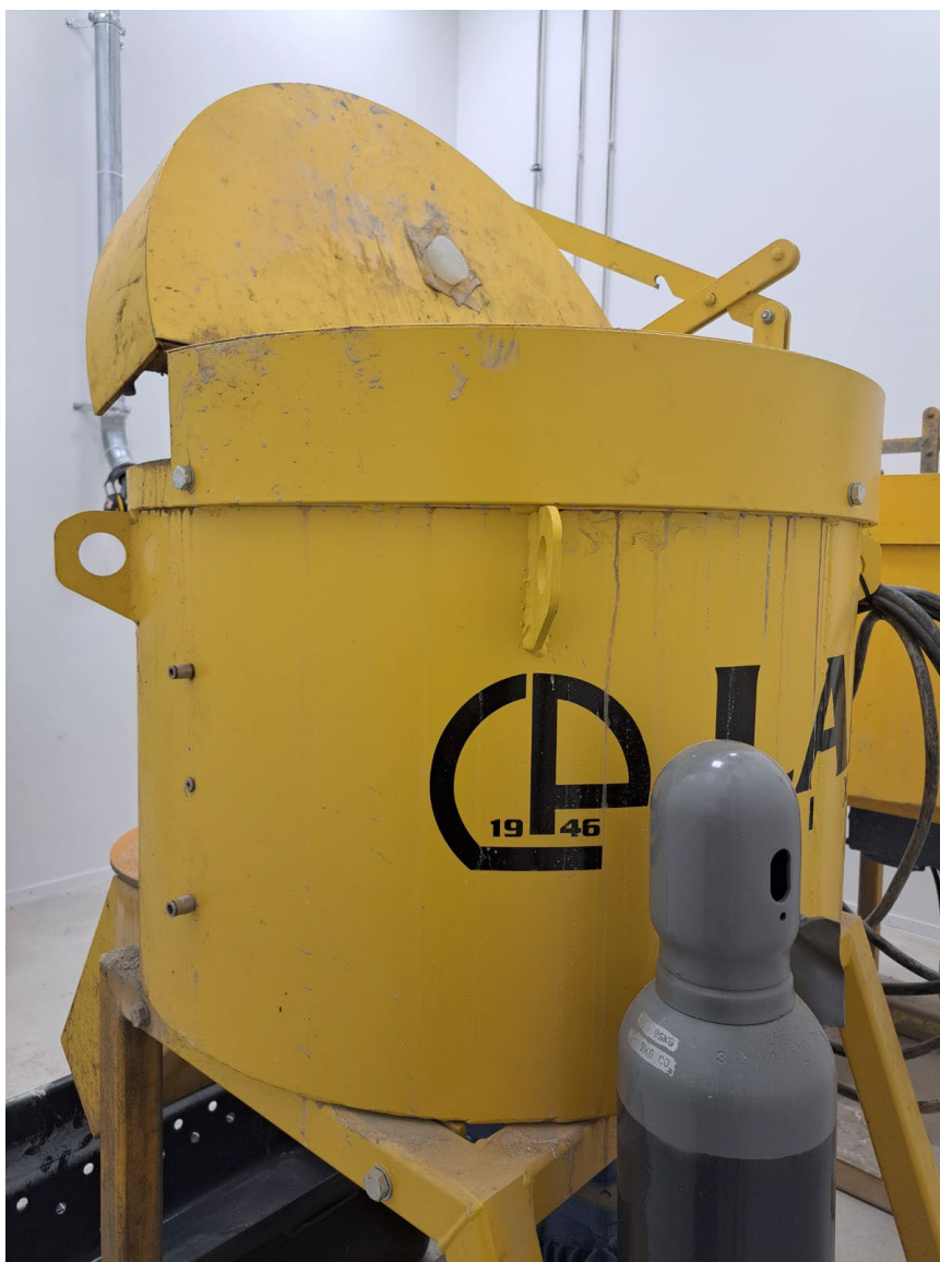
Kuva 4. Hiilidioksidisyöttöä varten muokattu tasosekoitin betonimassojen valmistamiseen
