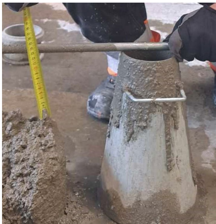
Kuva 8. Painuman mittaus tuoreesta betonista.
