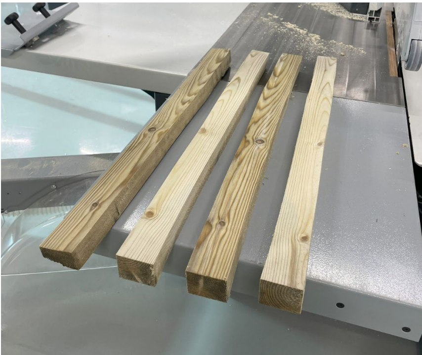
Kuva 5 Koekappale 1:stä sahatut sauvat taivutustestiä varten
