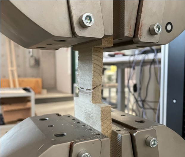
Kuva 7 Vetomurto syysuntaan nähden poikittain
