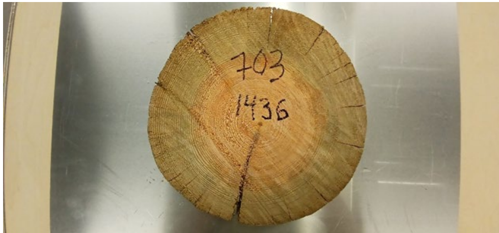
Kuva 1. Kosteusnäytekiekko ennen kuivausta. Alkupaino merkattu tussilla näytteen ID tunnuksen alle. Kuva Heikki Naumanen
