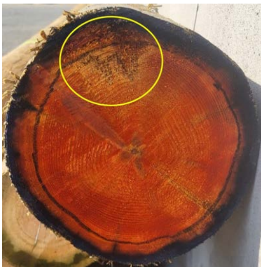
Kuva 9. Kuparireagenssikäsittelyn jälkeen kuparia sisältämätön alue värjäytyy oranssiksi ja erottuu tummasta, kuparia sisältävästä puuaineksesta selkeästi. Kuvan pylväs on kyllästynyt vain alle 20 % poikkileikkauksestaan. Kuva: Juho Peura
