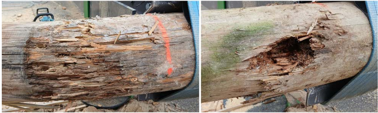
Kuva 4.1. Pylväät ANT1 (vasen) ja ANT3 (oikea). Näissä pylväissä on ollut joko runsas huuhtouma, vajaatunkeuma tai muu kyllästysprosessissa tapahtunut virhe. Myös em. yhteisvaikutus on mahdollista. Kuva: Kai Möller
