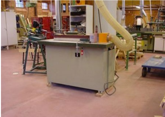
Kuva 9. Reunahiomakone SCM Unilev 150. Kuva Puulaboratorion arkisto
