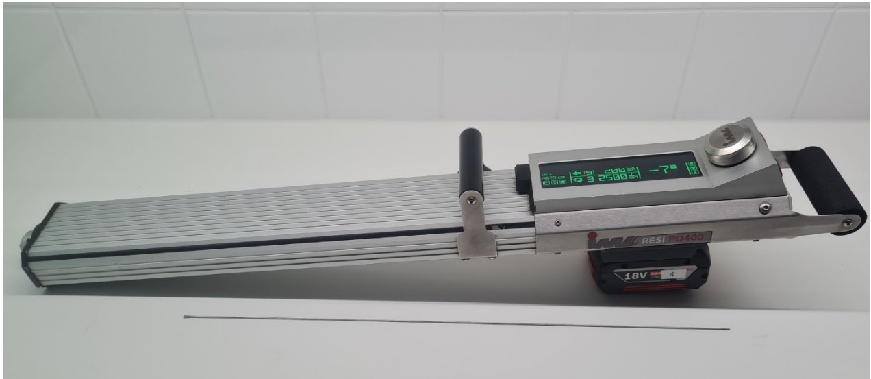
Kuva 18. Mikropora ja sen terä etualalla. Kuva: Wodeca/Petri Laitinen
