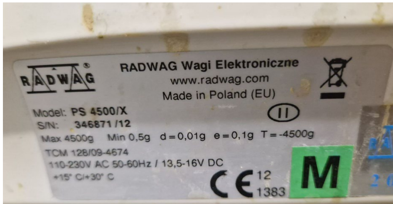
Kuva 3. Tarkkuusvaaka Radwag PS 4500/X, tekniset tiedot. Vaa'an etupuoli on kuvassa 2. Kuva Heikki Naumanen
