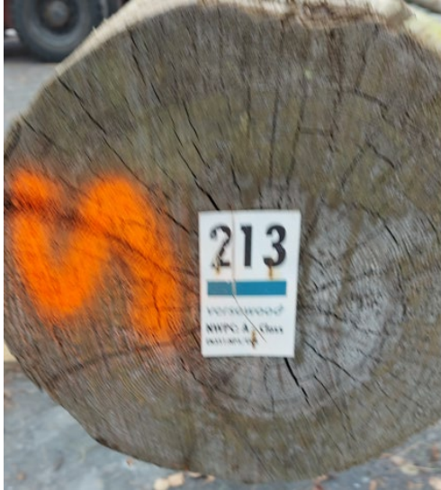
Kuva 13. Pylvään päästä löytyy pylväsluokka ja vanhemmissa pylväissä se on merkitty metallisiin lommeihin. Kuva: Kai Möller
