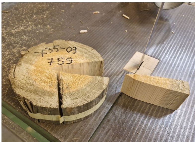
Kuva 5. Vuosilustonäytteen sahaus vannesahalla. Kuva Heikki Naumanen
