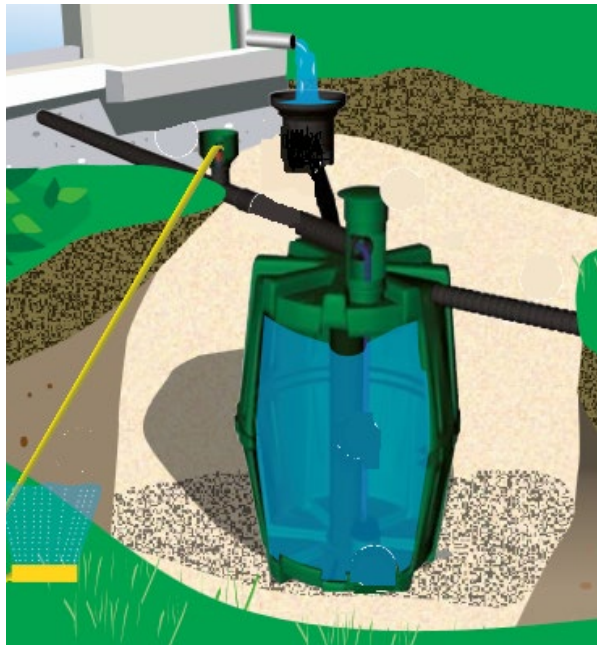
Hulevesikaivo (Meltex Oy)
