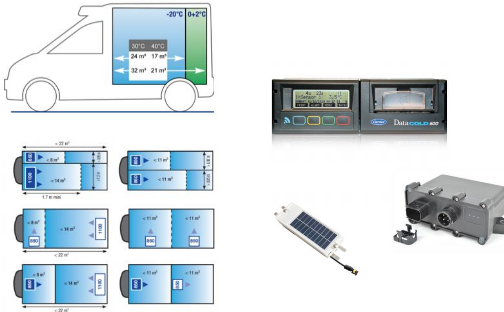
Kuva 2.16. Kuormatilan jakaminen eri lämpötila-alueisiin ja käytettäviä seurantalaitteita.
