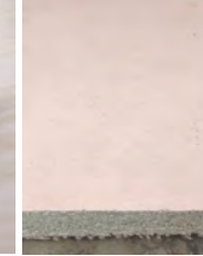
Savi-korsilevy: tiheys 890 kg/m 3 , vahvuus 16 mm, maalattu savimaalilla (savi, tärkkelys, pigmentti). Paloluokka A2.
