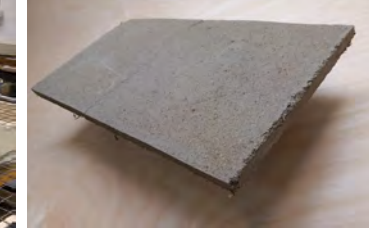
Savi-korsilevy: tiheys 890 kg/m 3 , vahvuus 16 mm, maalattu savimaalilla (savi, tärkkelys, pigmentti). Paloluokka A2.
